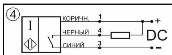
Схема соединения Нормально-разомкнутый контакт
